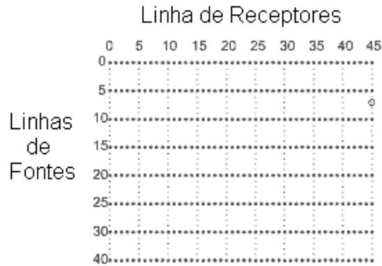
Figura 10: Exemplo de geometria de aquisição sísmica terrestre 3D. Neste caso, as linhas de tiro são perpendiculares as linhas de receptores.
