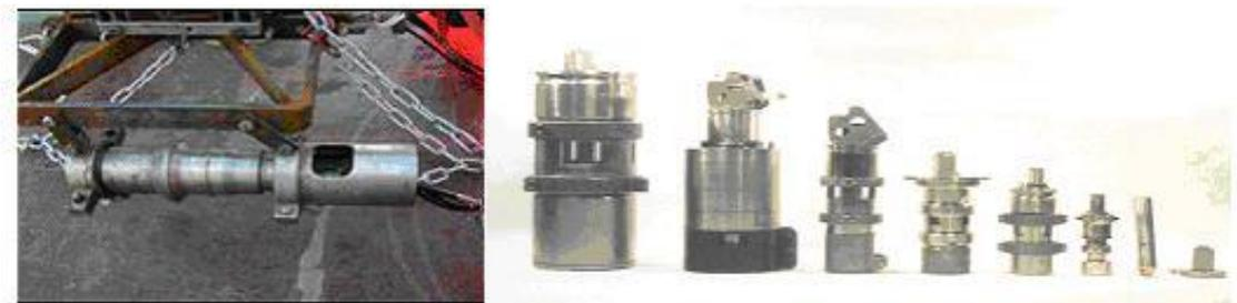
Figura 5: A esquerda um canhão de ar preso ao suporte que vai para a água e a direita uma família de canhões de ar.
