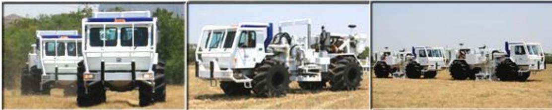
Figura 4: Exemplos de vibroseis. Normalmente usa-se de 2 a 5 para um levantamento sísmico.
