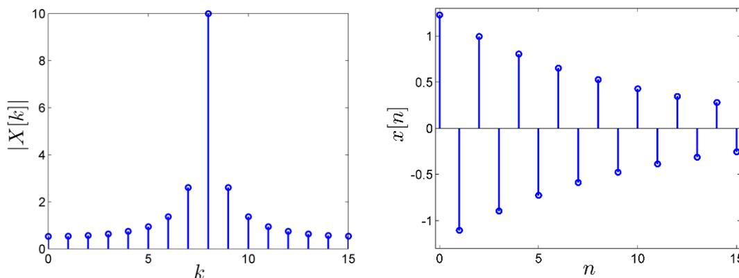
Figura 1. Módulo de  $X[k]$  (DFT<sub>16</sub>) e sequência estimada  $x[n]$  obtida pela IDFT<sub>16</sub> inversa de  $X[k]$ .
